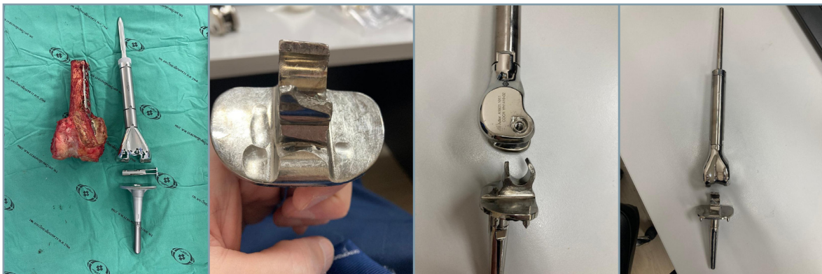
รูปที่ 5 ข้อเทียมมีปัญหาแตกหักที่ตรงตำแหน่งบานพับ
